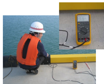
写真 3-3.2 電位測定状況
