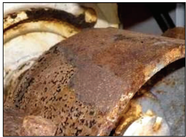
図Ⅱ-11.1 走行装置、電動機内蔵ブレーキの状況（ドラム式）、劣化度[a]
