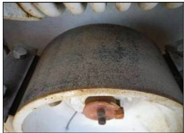
図Ⅱ-11.2 走行装置、電動機内蔵ブレーキの状況（ドラム式）、劣化度[c]
