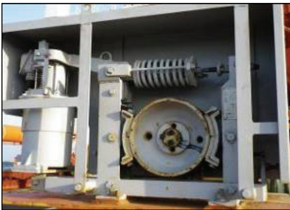
図Ⅱ-11.2 走行装置、電動機内蔵ブレーキの状況（ドラム式）、劣化度[c]
