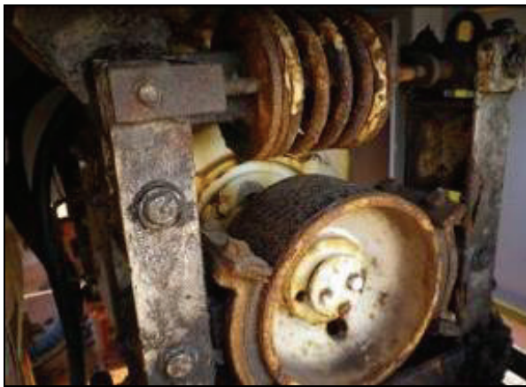
図Ⅱ-11.1 走行装置、電動機内蔵ブレーキの状況（ドラム式）、劣化度[a]
