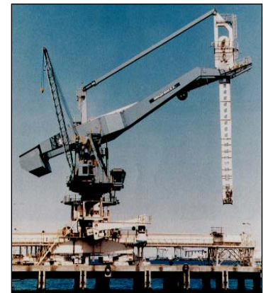
図 I-1.16 チェーンコンベア式連続アンローダの構造及び実機（例）
