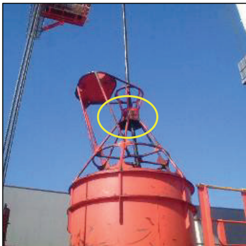
図Ⅱ-17 ケーブルバスケットの破損、劣化度[a]
