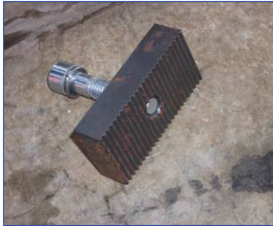
図Ⅱ-12.1 レールクランプの爪の摩耗状況、劣化度[d]
