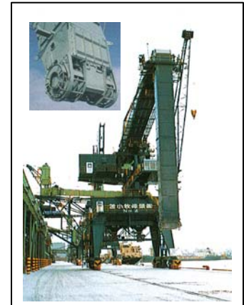
図 I-1.15 ベルトコンベア式連続アンローダの採集機構と貨物の流れ及び実機（例）
