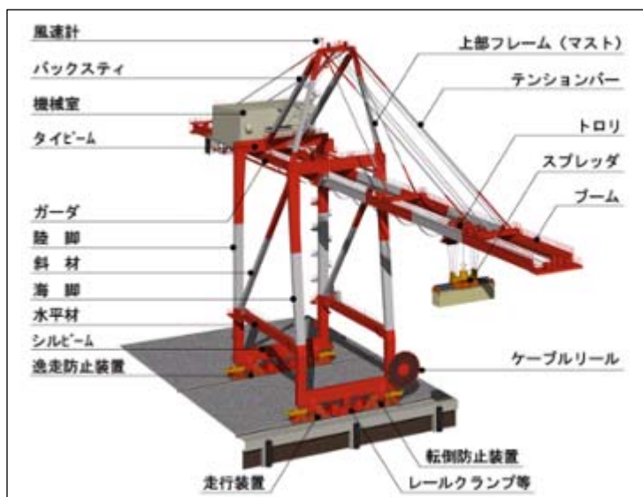
図 I-1.1 コンテナクレーンの全体
