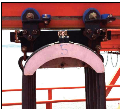
図II-10.1 ケーブルキャリアホルダ、劣化度[c]
