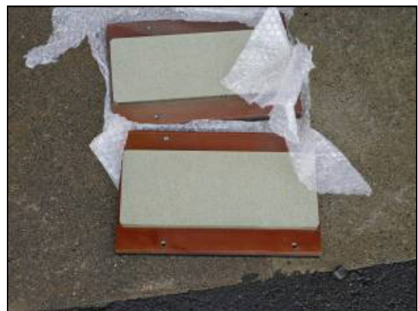
図Ⅱ-13.2 レールブレーキ・パッドの状況、劣化度[d]
