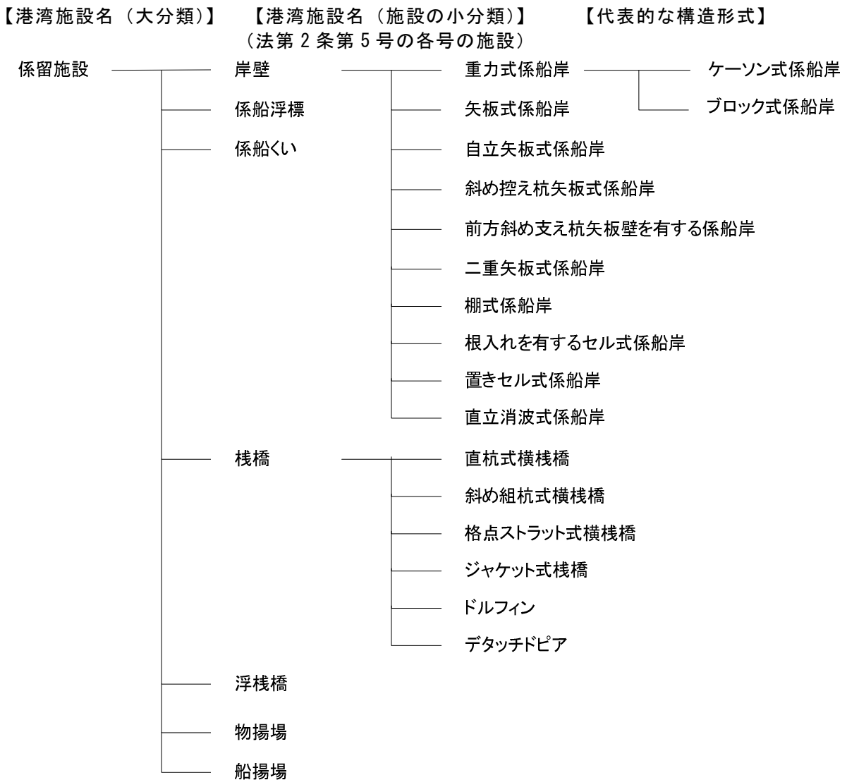
図 3-4.5 係留施設の種類及び代表的な構造形式
