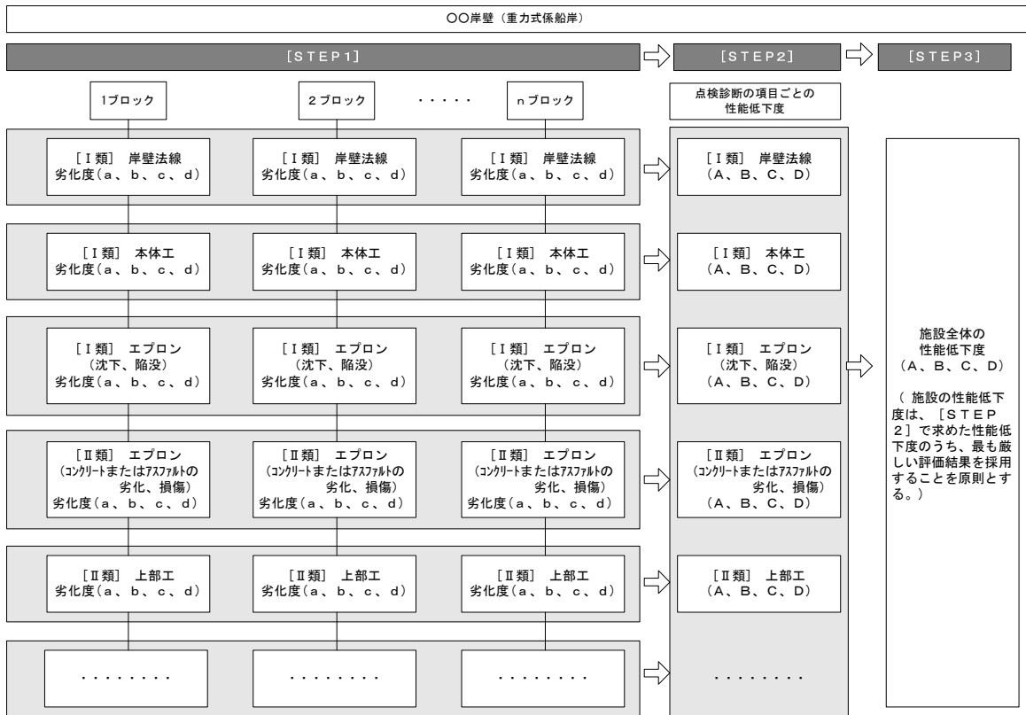
図-参 3-3.3 性能低下度の評価方法の流れ (重力式係船岸の場合)
