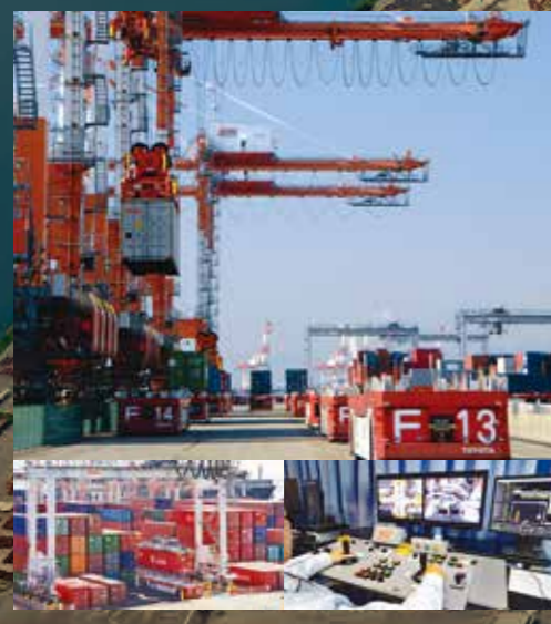
ガントリークレーンとヤード間を自動制御で往復する自動搬送台車 (AGV) を導入。遠隔自動RTGとの連携により荷役作業の更なる効率化が図られています。 Automated Guided Vehicles (AGV) shuttle between gantry cranes and yard areas under automatic control. Cargo handling operations are made more efficient in tandem with remote-controlled RTG.
