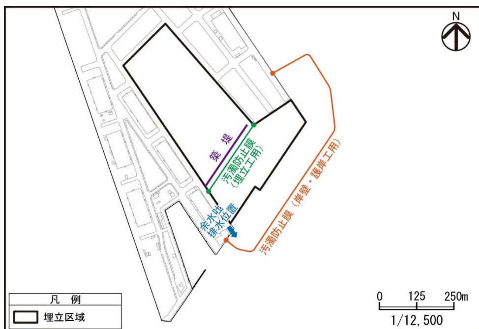
図 1-5(2) 築堤、余水吐及び汚濁防止膜の位置（変更後）
