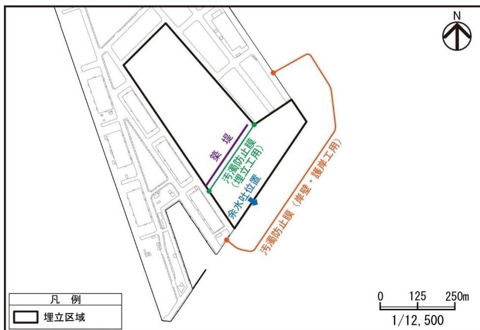
図 1-5(1) 築堤、余水吐及び汚濁防止膜の位置（変更前）
