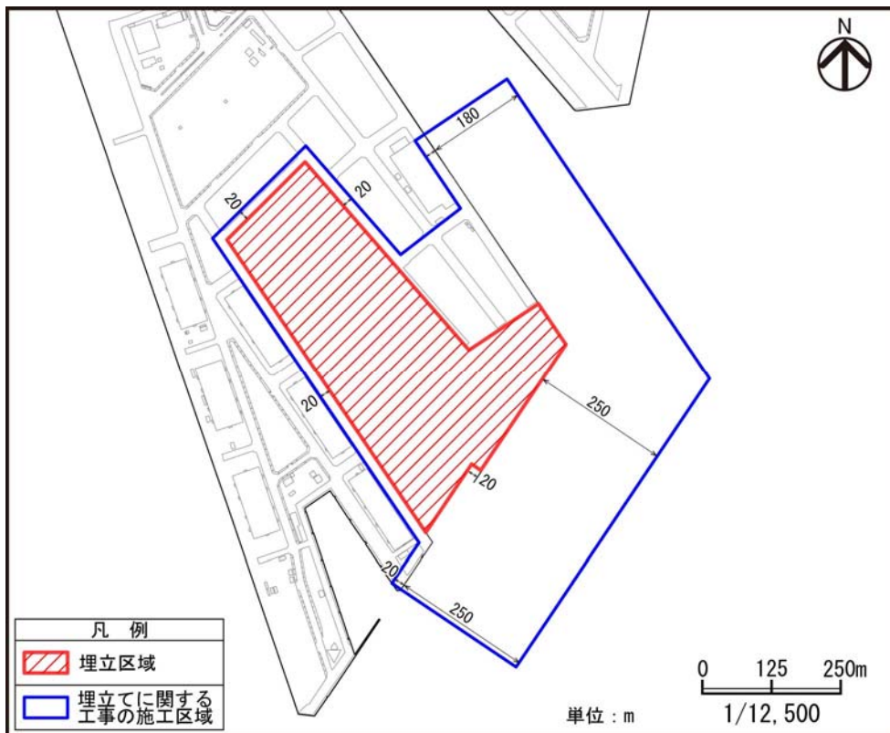
図 1-2(2) 埋立区域及び施工区域図（変更後）
