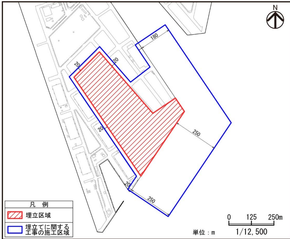
図 1-2(1) 埋立区域及び施工区域図（変更前）
