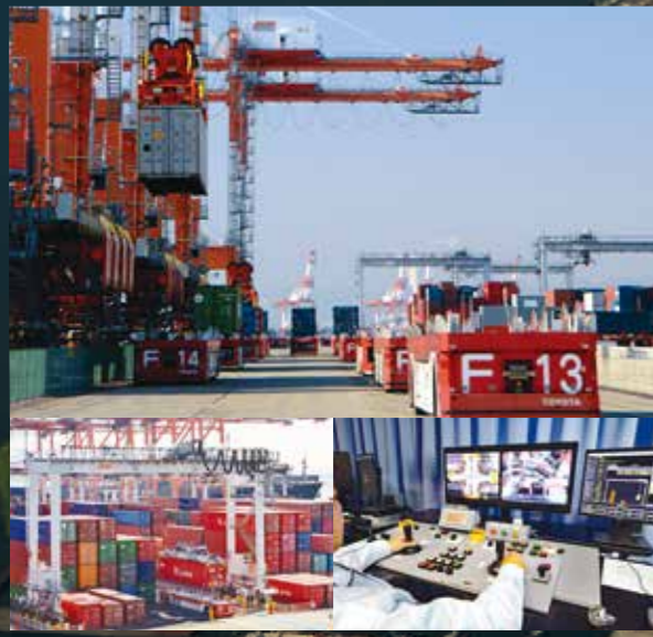
ガントリークレーンとヤード間を自動制御で往復する自動搬送台車（AGV）を導入。遠隔自動RTGとの連携により荷役作業の更なる効率化が図られています。
