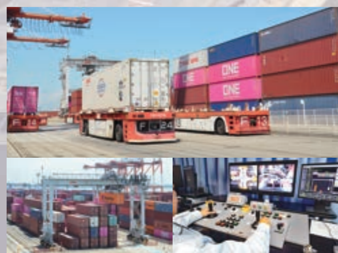
ガントリークレーンとヤード間を自動制御で往復する自動搬送台車(AGV)を導入。遠隔自動RTGとの連携により荷役作業の更なる効率化が図られています。
