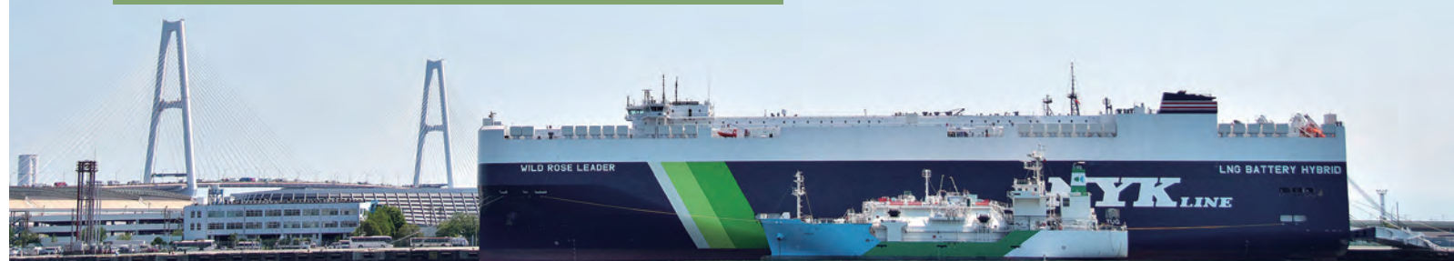
Ship-to-Ship方式によるLNG燃料自動車船への燃料供給 Ship-to-ship bunkering to LNG-fueled pure car and truck carrier
