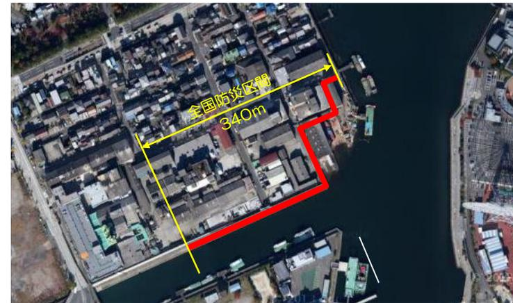
・昭和34年の伊勢湾台風の被害を受け、高潮対策として整備された防潮壁について、地震津波対策として液状化対策を実施。
