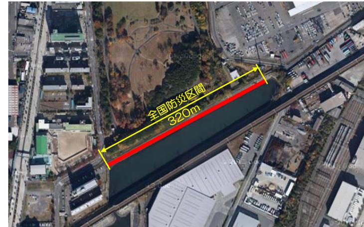
・昭和34年の伊勢湾台風の被害を受け、高潮対策として整備された防潮壁について、地震津波対策として液状化対策を実施。
