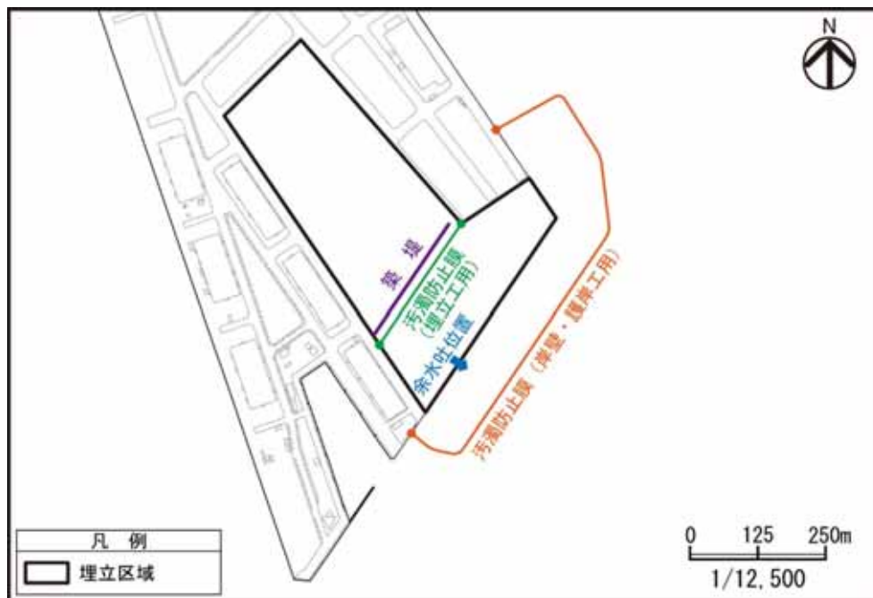
図 1-2-21 築堤、余水吐及び汚濁防止膜の位置
