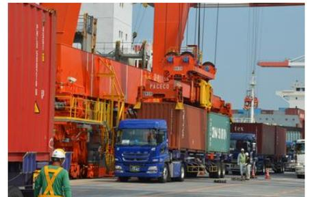
T3 のガントリークレーン。20ft コンテナを 2 個同時に吊り上げることができる ツインスプレッダーや免震装置を採用している。
