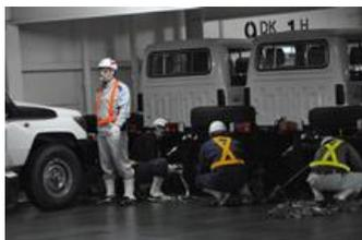
自動車専用船は、一度に約5,000台もの車を運ぶことができます。その自動車専用船への車の積み込みは、監督者1名、足車ドライバー1名、積込車ドライバー5名、船内車付役2名、車固定役6名からなる「ギャング」という組を編成して行われます。ギャングの数は車の積み込み台数によって変わりますが、1ギャングが1日に積み込む台数は約500台。大型船では5ギャングが編成され、台数によっては2日かかりで積み込みが行われます。
