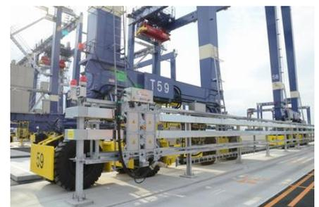
架線から給電を受けるバスバー方式の RTG
