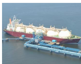
着栈中のLNG船（モス型）
