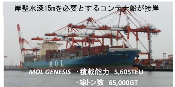
東南アジア航路が就航する飛島ふ頭東側(NCBコンテナターミナル)において、既存の岸壁水深12mを超える大型コンテナ船が増加しており、喫水調整して接岸するなどの対応が行われている。
