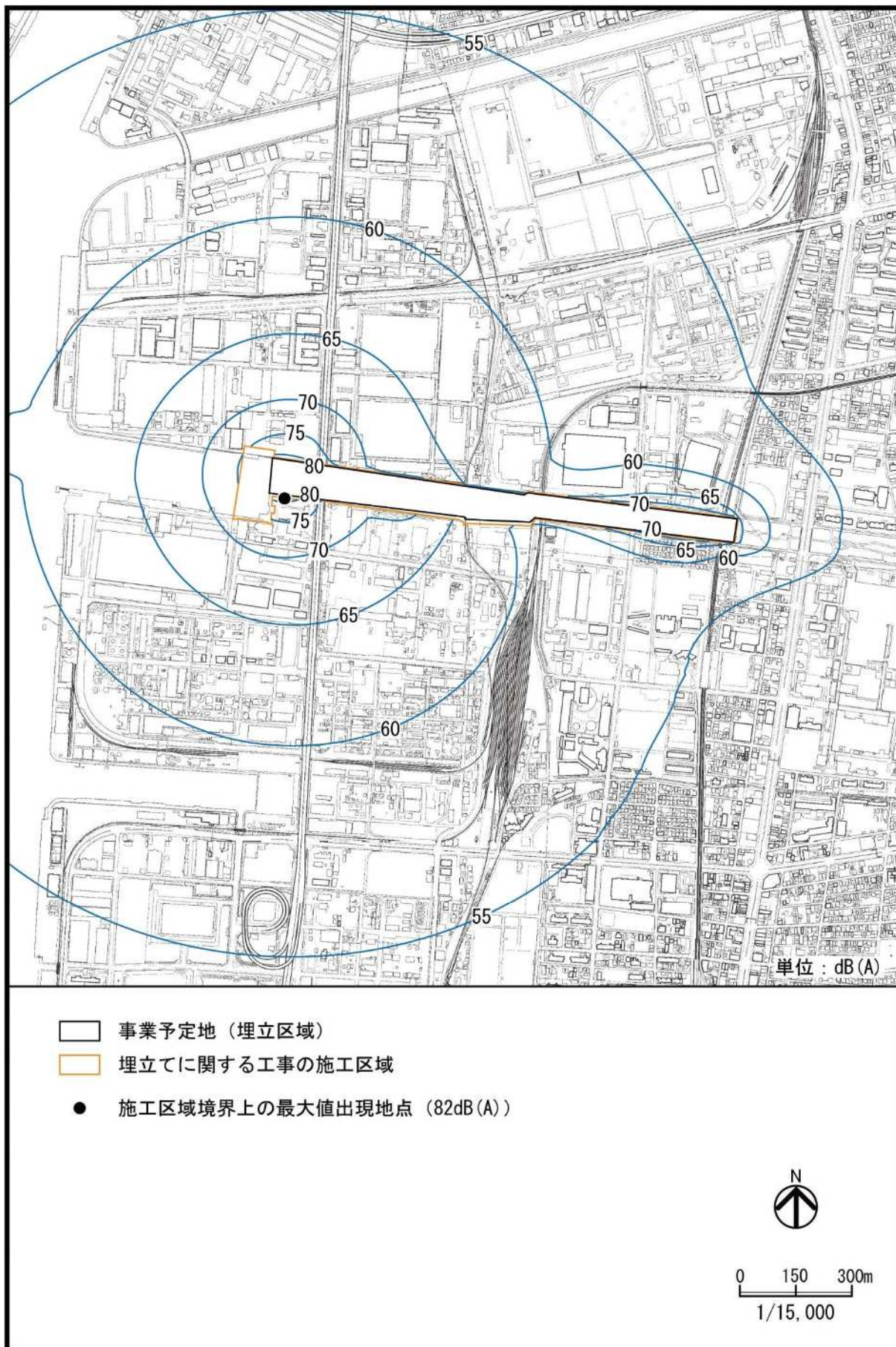
図 2-3-4 建設機械の稼働による騒音レベルの予測結果
