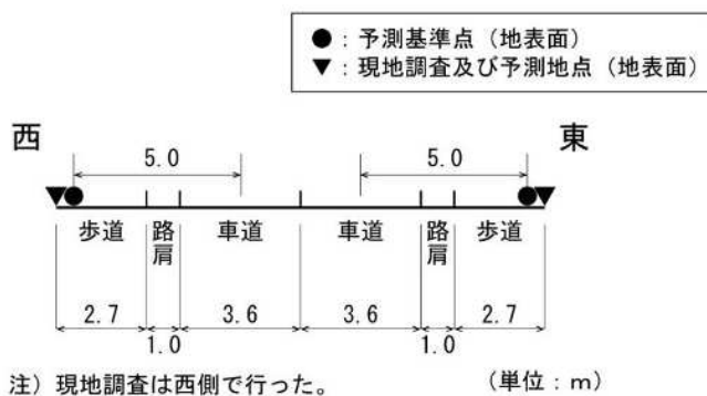
図 2-4-6 予測基準点の位置 (道路断面方向の配置イメージ：No. 4 の例)
