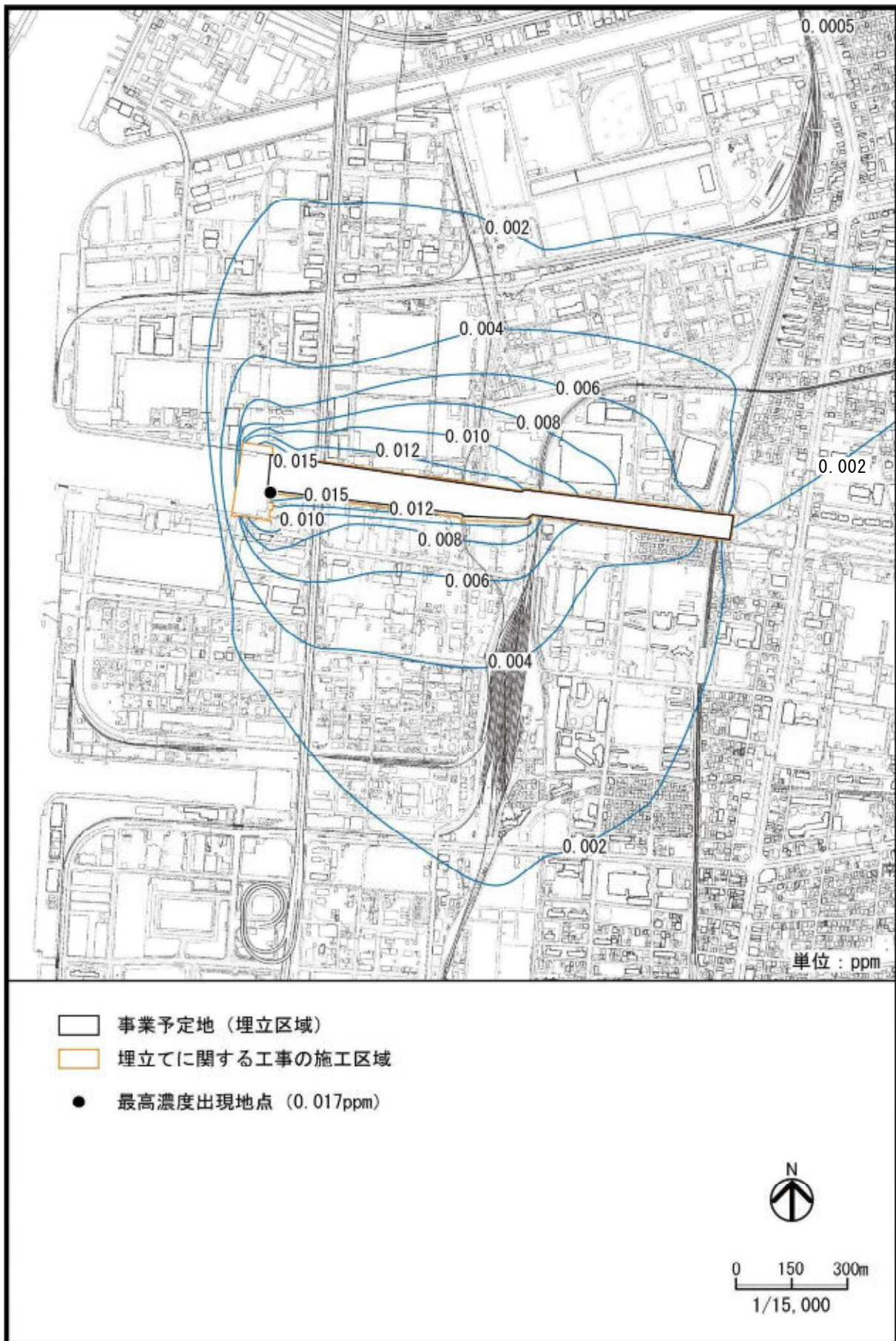
図 2-1-13(1) 建設機械の稼働による二酸化窒素濃度の予測結果 (年間排出量最大時)
