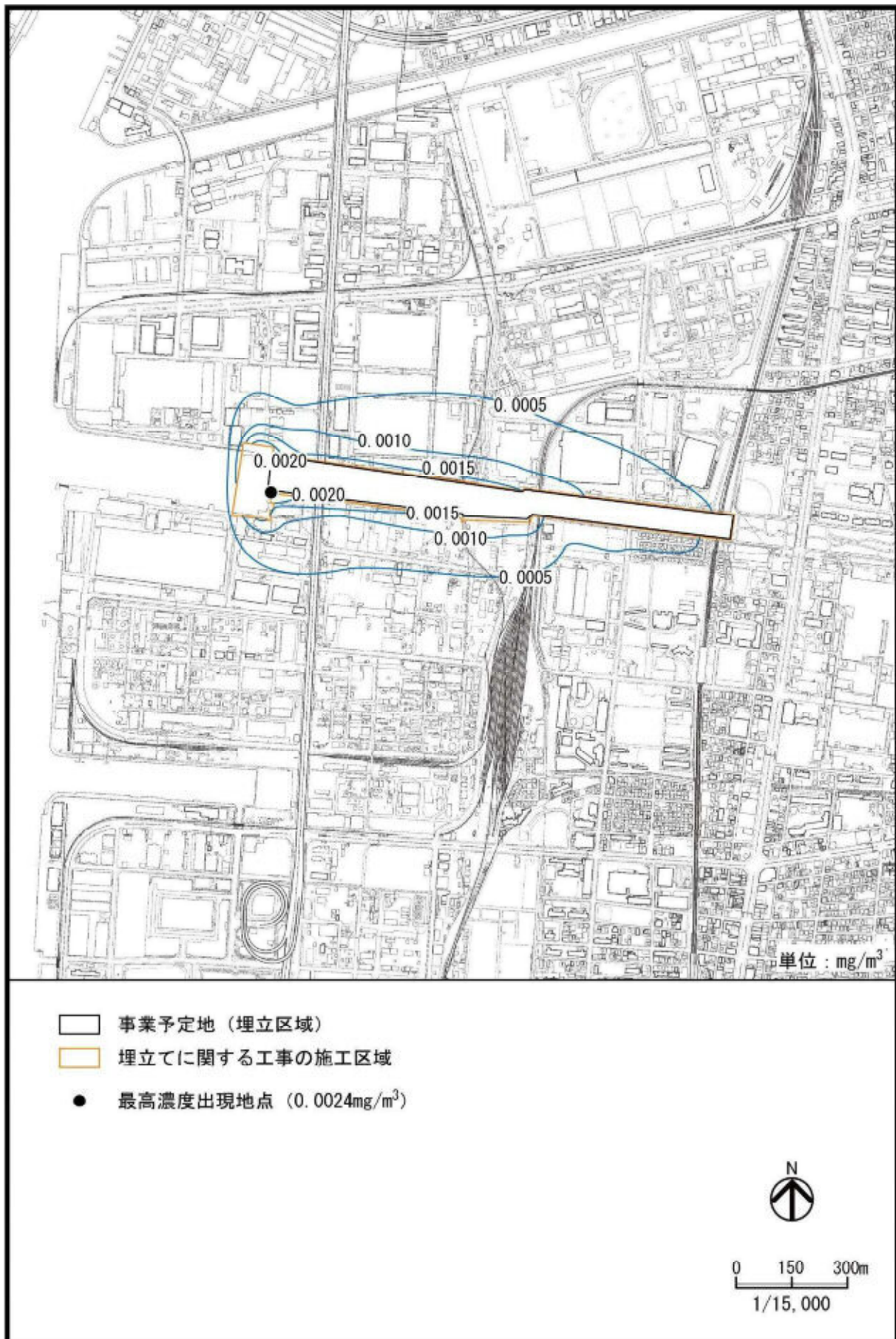
図 2-1-15(1) 建設機械の稼働による浮遊粒子状物質濃度の予測結果(年間排出量最大時)
