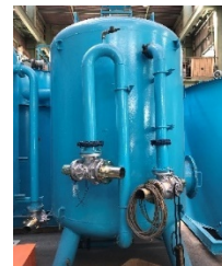
活性炭吸着塔
