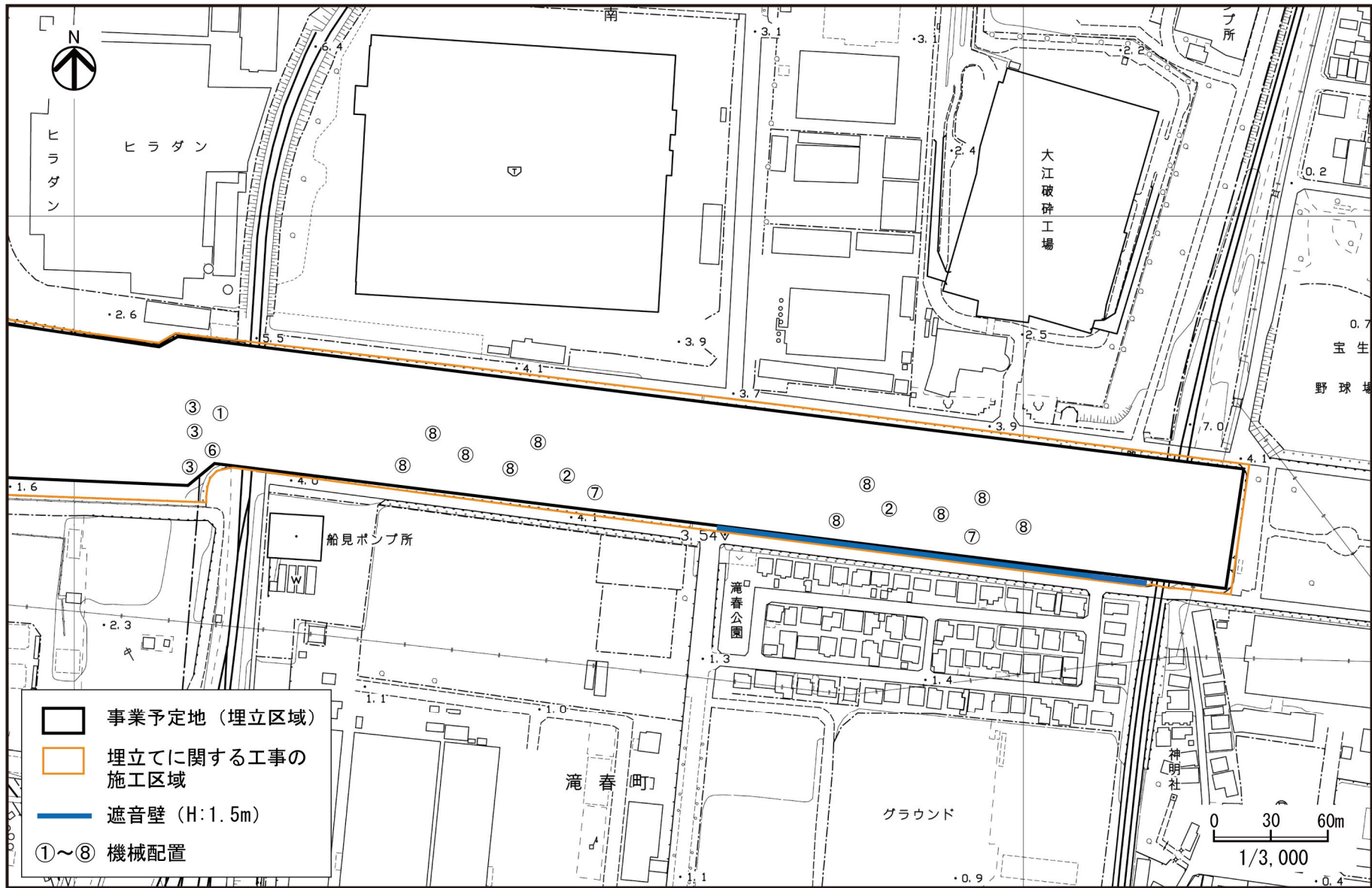
図 5-11-2(2) 建設機械の配置図 (上流側)
