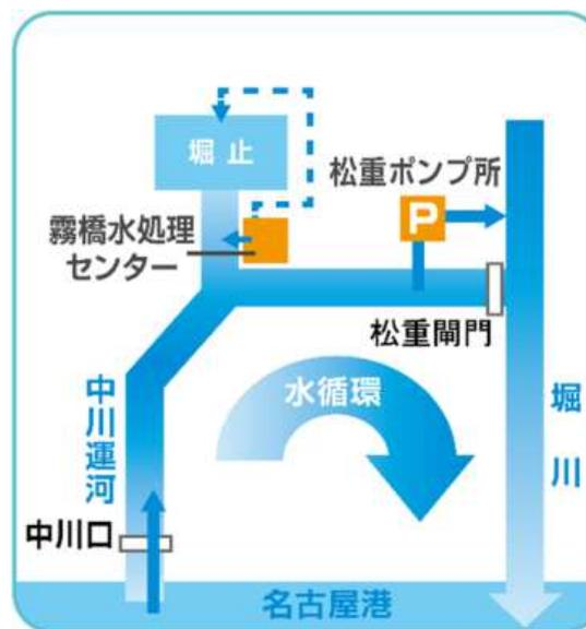
中川運河において、露橋水処理センターからの高度処理水を堀止等から放流するとともに、中川口から海水を取水し、松重ポンプ場から放流する水循環を行い、水質改善を行っている
