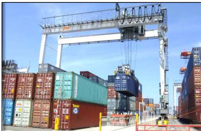
遠隔自働RTGとAGVの自働荷役 (アイドリングストップ・夜間消灯自働荷役)
